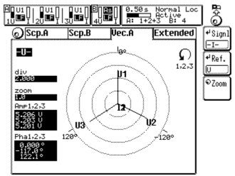
Figure 31: Vector (Fresnel) diagramm
