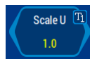
Abbildung 7.3: Softkey, der einen Zustand anzeigt. Die Stromskalierung ist 1.0. Durch Druck auf dem linken/rechten Softkey kann man diesen Wert in Stufen verändern. Ein langer Tastendruck öffnet in diesem Kontext einen Dialog zur Eingabe eines Skalierungswertes.
