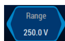
Abbildung 7.7: Ein deaktivierter Softkey, der trotzdem einen Status anzeigt. Das Verhalten ist ähnlich wie bei Abbildung 7.6 [→149], jedoch wird eine aktuelle Einstellung angezeigt. So etwas passiert häufig in Zusammenhang mit automatischen Funktionen. In diesem Beispiel ist die Auto-Range-Funktion aktiv, so dass man keinen Bereich von Hand wählen kann. Der Softkey zeigt trotzdem den aktuell eingestellten Bereich an.
