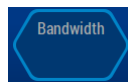
Abbildung 7.6: Deaktivierter Softkey. Er kann im aktuellen Kontext keine Aktion durchführen. Ein Druck hat keine Auswirkung. Durch eine Änderung im Kontext kann dieser Softkey wieder aktiviert werden, wenn er benötigt wird.
