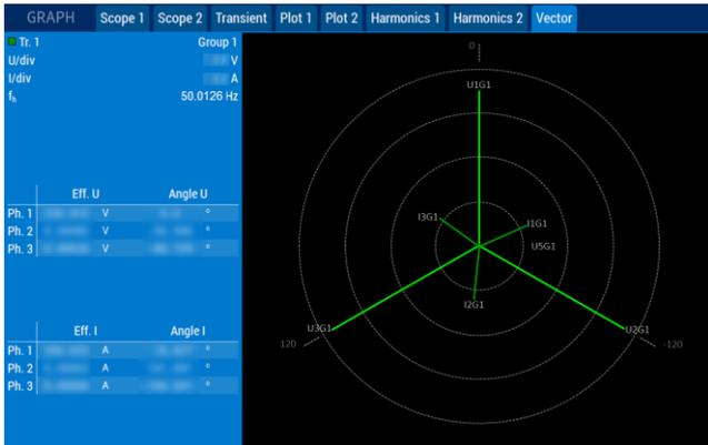
Abbildung 13: Vektordiagramm – Auszug LMG671 Scope-Menü zur Prüfung der Phasensymmetrie
