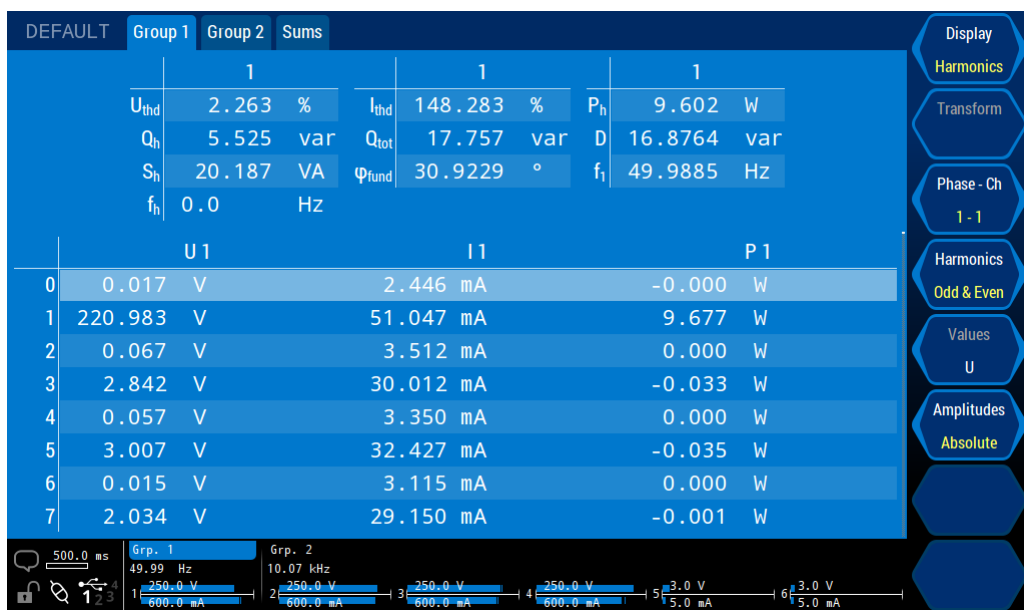
Abbildung 7.14: Standard-Menü mit Harmonischen Werten. Das [DEFAULT] Menü zeigt in dieser Einstellung die Spannungsharmonischen aller Phasen der Gruppe 1.
