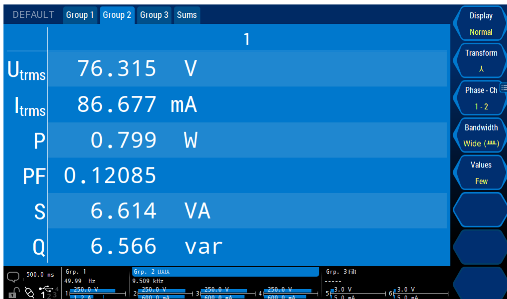
Abbildung 7.11: Standard Menü mit Werten der ersten Gruppe. Man sieht zyklusbasierte Werte im Default Menü. Die Werte sind schmalbandig von der ersten Phase der Sternschaltung der ersten Gruppe.
